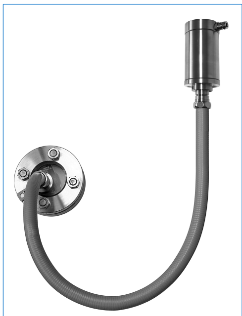
Projecteur adf à fibre optique entièrement en acier INOX, type fibroLUX E d PowerLED Sch W2 K2, Ex II 2 G + D, 7 W, 230-240 V AC, fixation de la source lumineuse avec charnière «Sch», fixation de la fibre optique avec collier «W2» sur hublot selon DIN 28120, DN 40, PN 10
